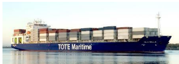
World's 1 st LNG driven container vessel
